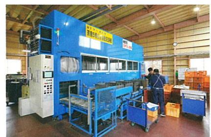
大型サイズ、多ロットにも対応できる炭化水素系洗浄の双発5槽式全自動洗浄装置。単槽の洗浄装置もあり、2台体制でリスク軽減にも努めている。
