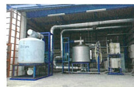
大型サイズ、多ロットにも対応できる炭化水素系洗浄の双発5槽式全自動洗浄装置。単槽の洗浄装置もあり、2台体制でリスク軽減にも努めている。
